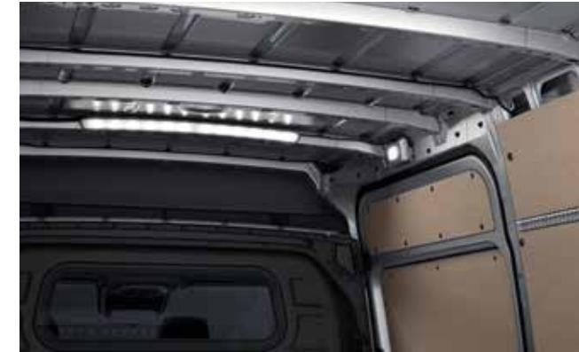
Dvije LED svjetleće trake ispod krova osvjetljavaju utovarni prostor pri čemu gotovo da nema sjena, poboljšavajući tako orijentiranje prilikom utovara i istovara.
