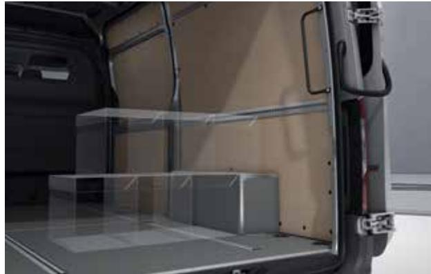
Drvena obloga kućišta kotača omogućava bolji utovar u utovarnom prostoru i štiti lim od oštećenja.
