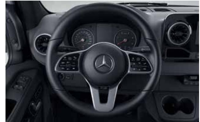
Zahvaljujući multifunkcijskom upravljaču, moguće je rukovati komandnim računalom, funkcijama vozila i multimedijskim sustavima pomoću tipke ili dugmeta osjetljivog na dodir, bez micanja ruku s upravljača.
