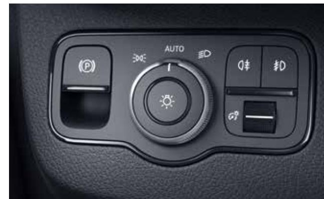
Električnom parkirnom kočnicom može se jednostavno i komorno upravljati pritiskom na dugme, a budući da nema poluge parkirne kočnice omogućeno je bolje kretanje prema natrag.
