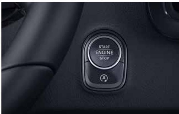
Jednostavno pokretanje motora pritiskom na dugme: sustav autorizacije vožnje KEYLESS-START omogućava pokretanje motora samo pritiskom gumba start-stop u bravi paljenja.
