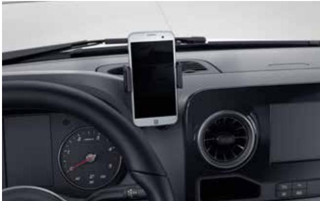
Univerzalni držač pametnog telefona koji omogućava korištenje raznih mobilnih uređaja u vozilu instaliran je u visini očiju i nadohvat ruke vozača.
