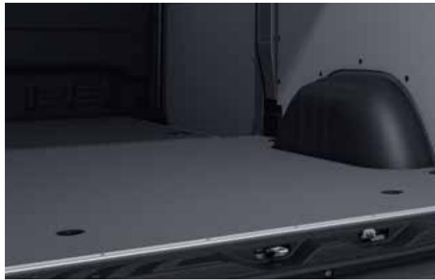
Plastični pod optimirane težine omogućava bolju iskorištenost utovarnog prostora zahvaljujući svojoj ravnoj površini te jednostavnije održavanje kao i smanjenje mase od cca 18,5 kg<sup>2</sup> u usporedbi s drvenim podom.
